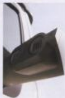
Al posto degli specchi retrovisori, l'Optifuel Lab monta un sistema di telecamere, completo da 3 unità + 1 specchio per la retrovisione.
